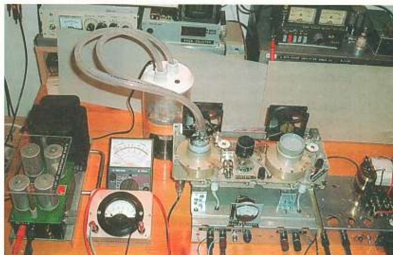
Overzicht op de opstelling met van links naar rechts: hoogspanningsvoeding, meting, koeling, eindtrap en de gloeispanningsvoorziening.
